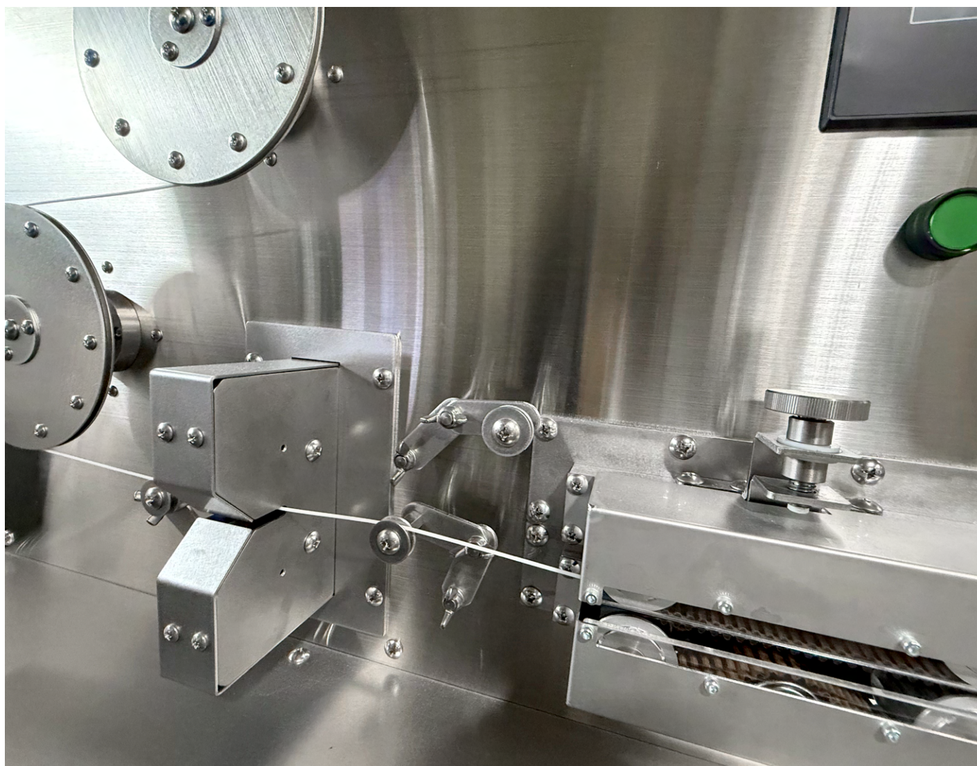
フィラメントの直径を検知するセンサー
