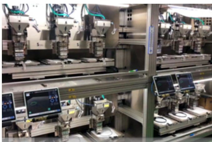
TOKYO2020 表彰台製作の ために開発した 12 連ペレットヘッド機
