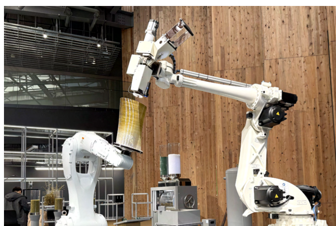
EXPO2025 大阪 日本館用スツール REN 製作のために開発された ダブルアームペレット機
